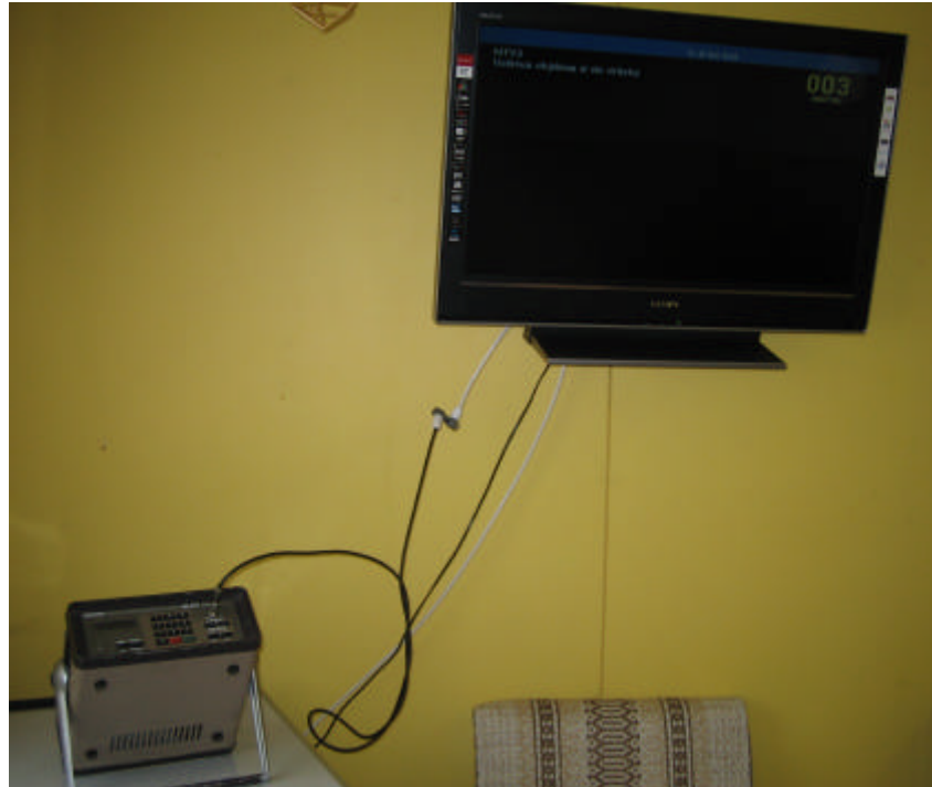
KUVIO 40. Antennitasojen mittausta kerhohuoneesta. Kuvassa näkyy myös uusi Sonyn digitv
