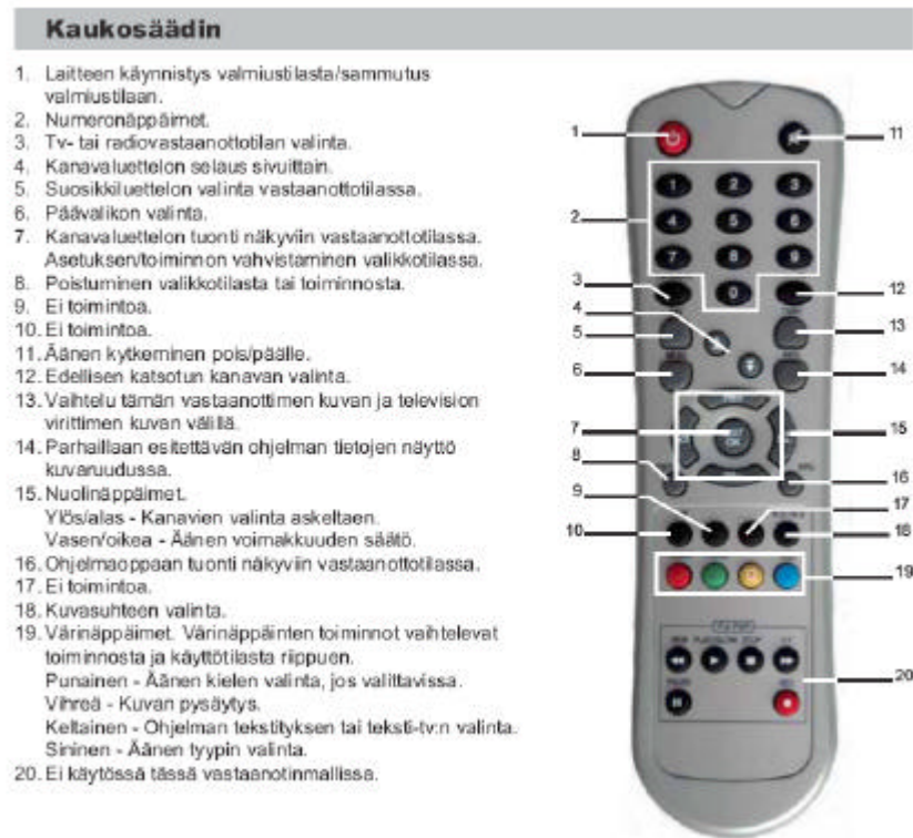
KUVIO 39. Vision VDT 1020 digisovittimen kaukosäädinkomennot (Vision VDT 1020 käyttöopas)
